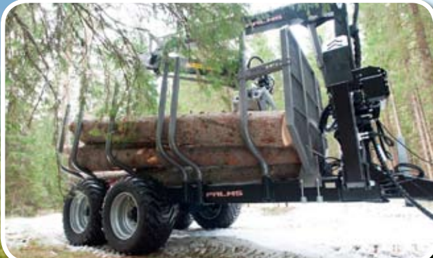
Palms Estonia: Remorci forestiere dotate cu braț de încărcare
